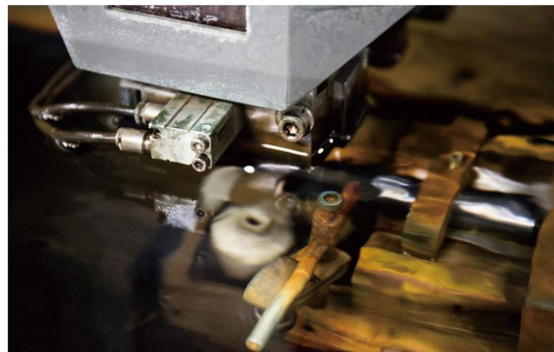
ワイヤ放電加工機で加工中のダイヤモンド工具。
