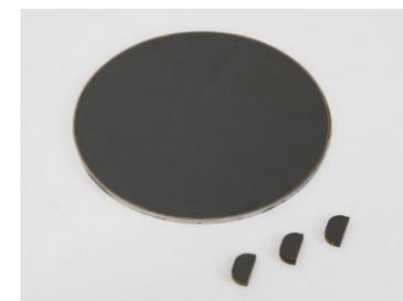
ワイヤ放電加工機でダイヤモンドウエハから切り出されたダイヤモンドチップ。
