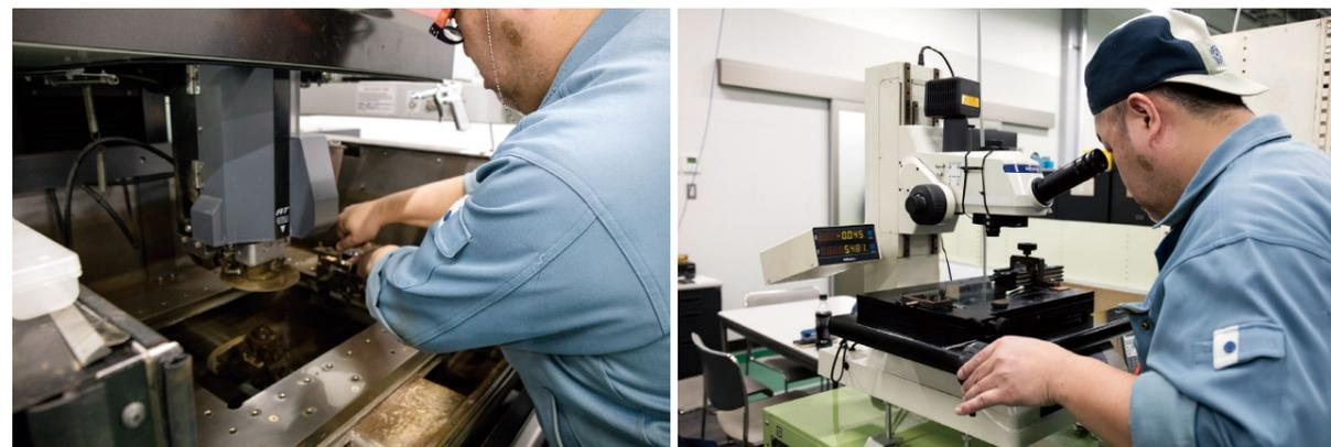
ダイヤモンド切削工具の製造工程。工業用ダイヤモンドの刃をワイヤ放電加工機で加工し（左）、顕微鏡で精度を確認。この作業を繰り返して仕上げていく。
