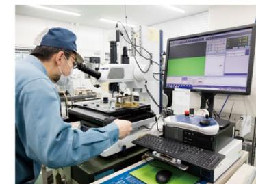
出荷前の最終検査工程。ベテランの担当者が、ディスプレイで拡大表示した顕微鏡画像から加工精度を確認する。
